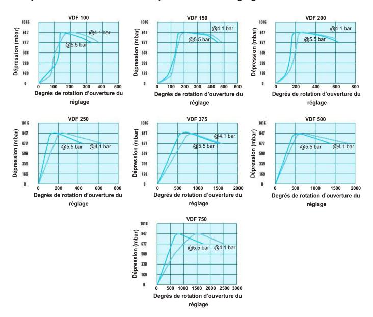
Nombre de degrés d'ouverture du réglage nécessaire pour l'obtention des niveaux de dépression indiqués (mbar)
