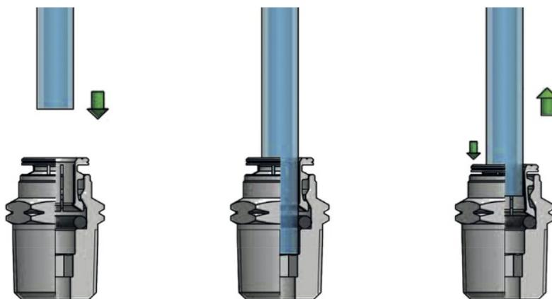
Une fois effectué le branchement, s'assurer que le tube inséré dans le raccord n'est soumis à aucune force de traction. Il est également nécessaire de respecter, lors du branchement du tube, le rayon minimum de courbure conseillé.
