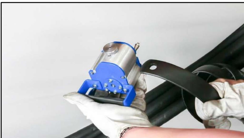
6. Tourner la molette (en tournant le bouton dans le sens inverse des aiguilles d'une montre) jusqu'à obtenir une résistance. Augmenter le serrage si un glissement se produit au cours de l'utilisation.
