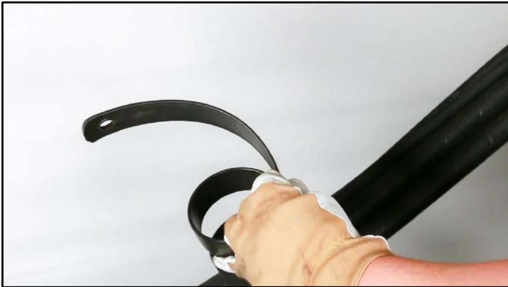
5. Pousser l'extrémité de la spirale redressée à l'intérieur du Safe-Bundler sur environ 15 cm, de manière à ce qu'elle sorte de l'autre côté de l'appareil.
