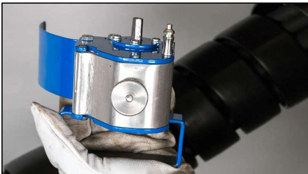
4. Redresser l'extrémité de la spirale sur environ 15 cm. Cela facilitera l'introduction de la spirale dans la chambre d'alimentation et lui permettra de s'enrouler ensuite plus facilement autour du faisceau de flexibles pendant le processus.
