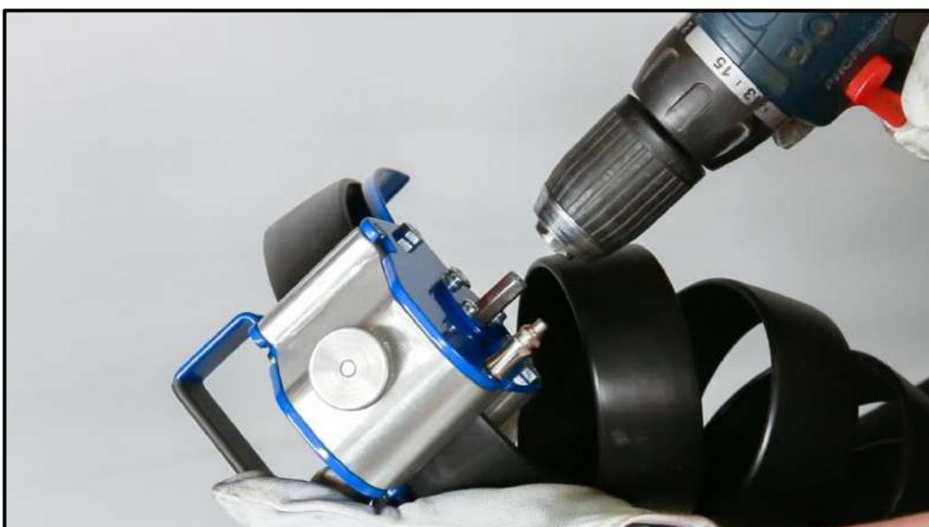
8. Tenir fermement l'outil avec la main gauche et utiliser la perceuse avec la main droite.
