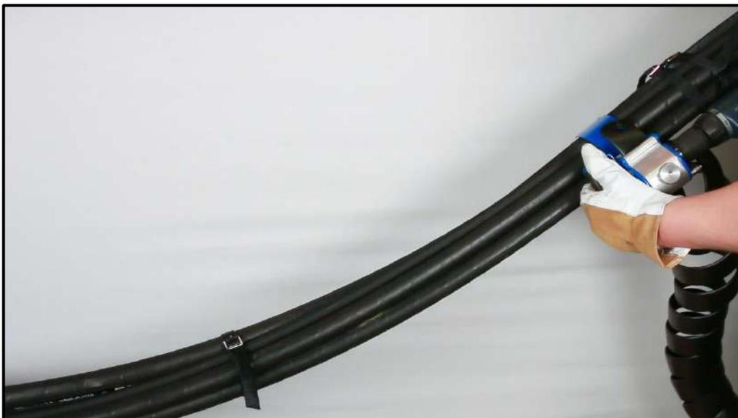
10. Commencer maintenant le processus de montage en activant la perceuse. D'abord lentement pour vous assurer que la spirale s'enroule correctement autour du toron. Puis plus rapidement si nécessaire.
