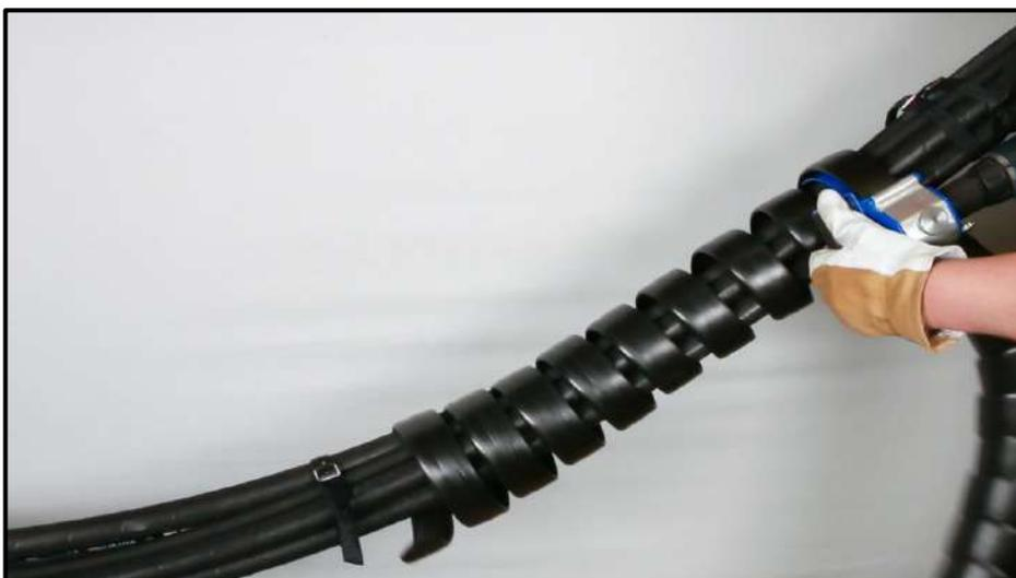
12. Il est possible que vous deviez intervenir manuellement afin que la partie en spirale installée se positionne correctement sur le faisceau de tuyaux. Dans ce cas, assurez-vous que la perceuse soit complètement arrêtée au préalable. Remplacez ensuite le support correctement sur le faisceau de tuyaux, vérifiez l'angle de la spirale et continuez le processus. Soyez toujours prudent lors du processus d'enroulement !
