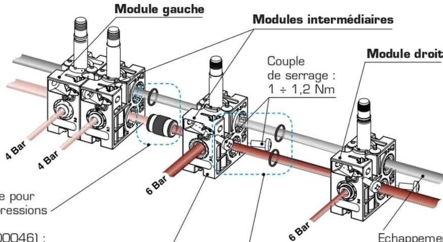
Kit d'assemblage pour batteries avec pressions différenciées (code : 1130C00046) : permet d'alimenter la même batterie avec 2 pressions différentes.
