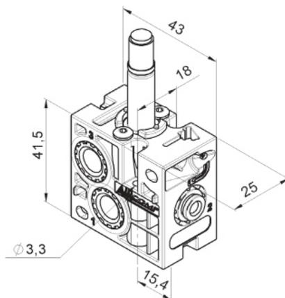
Fixation : avec vis 3 x 30 ou sur barre Omega DIN EN50022 (35mm) à l'aide du kit vendu séparément .
