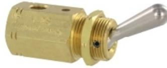
La gamme des interrupteurs pneumatiques à levier M-TV / M-MTV permet de contrôler la circulation d'un fluide dans un espace réduit. Les interrupteurs 2/2 ont pour fonction d'ouvrir et fermer une alimentation en fluide. Les 3/2 possèdent un échappement relié à l'atmosphère.
