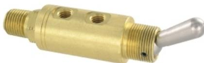
La gamme des interrupteurs pneumatiques à levier M-TV / M-MTV permet de contrôler la circulation d'un fluide dans un espace réduit. Les interrupteurs 2/2 ont pour fonction d'ouvrir et fermer une alimentation en fluide. Les 3/2 possèdent un échappement relié à l'atmosphère.
