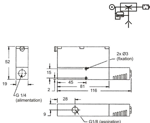
**KVP2X - Venturi avec silencieux, fonction de contre-soufflage calibré à déclenchement automatique instantané et plan de pose pour vacuostat embarqué**
