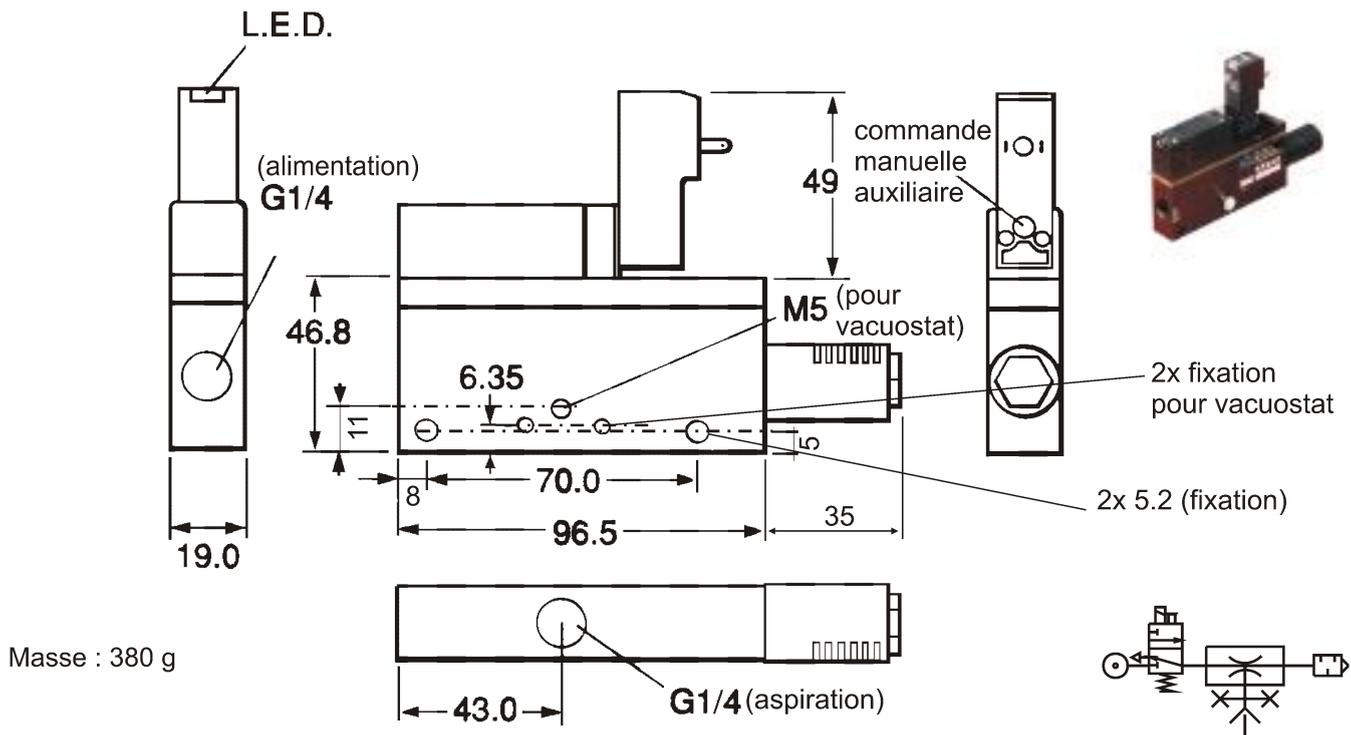
**KVP 61 (6M à 15M ou 6H à 15H). Pompe à vide à effet Venturi avec silencieux, électrodistributeur d'alimentation, piquage pour vacuomètre et plan de pose pour vacuostat embarqué. Contre-soufflage calibré à déclenchement automatique à la coupure d'alimentation électrique**
