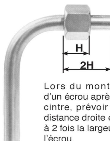
Lors du montage d'un écrou après un cintre, prévoir une distance droite égale à 2 fois la largeur de l'écrou.
