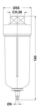
Permet d'éliminer les liquides condensés dans les tuyauteries, sans aucune intervention manuelle.
